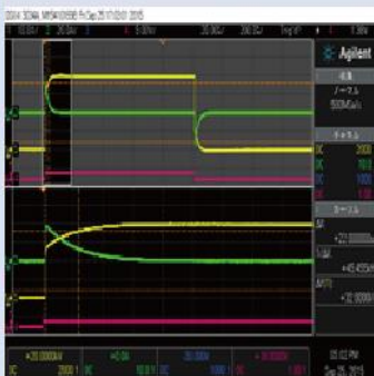
【正極性出力】1ms,40kV 出力
